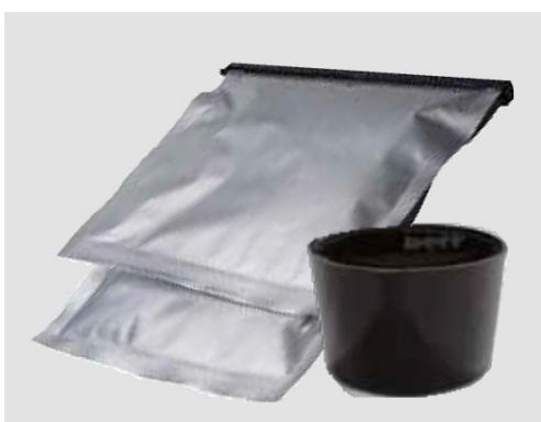
EGレジンはセルパックの直線接続材の絶縁防水用として30年以上の歴史を持つ万能型ポリウレタンレジンです。アルミパックに主剤と硬化剤がセパレーターで分離されており、作業時にセパレーターを外し、アルミパックを揉むように3分混合し、その後端部を切り取って直接注入することができます。
