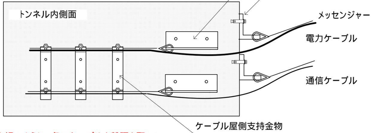
上記のように2条のケーブルを離隔を取って吊架する場合に適しています。
