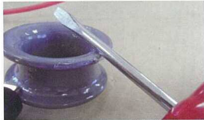
丸シンプル塗装品絶縁性試験 (ダイエィテック内)
